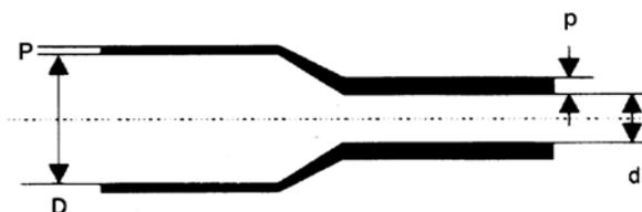
El **HFT** es un tubo termorretráctil de poliolefina irradiada y reticulada, con ratio de **contracción 2:1**, libre de halógenos, flexible y retardadora de la llama. Ampliamente utilizado en lugares cerrados donde se requieren estas características, tal como en automóviles, edificios, transportes colectivos, barcos, etc.
