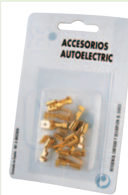
Ref. 67-15222-00 10 terminales mixto macho-hembra de 6,3 x 0,8 mm 2 . Sección de 0,75 a 1,5 mm 2 .
